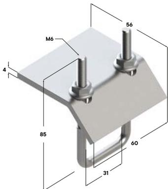
Монтаж профиля при помощи балочного зажима к конструкциям из профильного металлопроката (тавр, двутавр, швеллер). Крепление без применения сварки. Возможно использование в конструкции модулей для замещения серийных опор ГОСТ, при раскреплении легких технологических трубопроводов из композитных материалов, воздухопроводов, вентиляционных коробов. Рекомендуется для применения в сухих, влажных помещениях и на улице.
