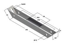
Увеличение несущей способности подвесов и консолей. Монтаж настенных консолей различной длины с укосинами. Поддержка всех типов консолей средних и тяжелых систем из 38/41 монтажного профиля в том числе установленных на стенах.
