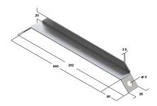
Увеличение несущей способности подвесов и консолей. Монтаж настенных консолей различной длины с укосинами. Поддержка всех типов консолей легких и средних систем из 28/38 монтажного профиля в том числе установленных на стенах.
