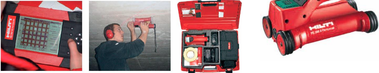
Рисунок 3: Определение местоположения армирования с помощью PS200
