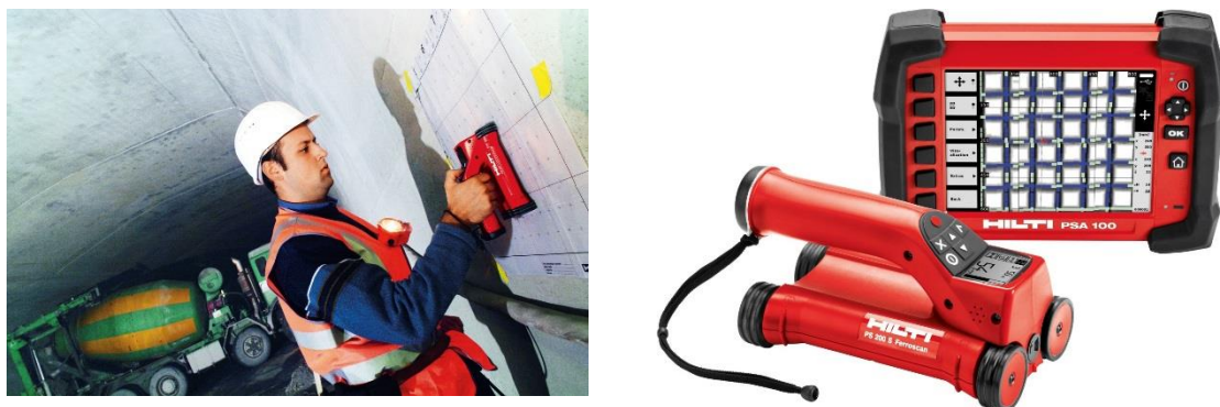
Рисунок 10.1 - Внешний вид прибора Hilti PS 250
