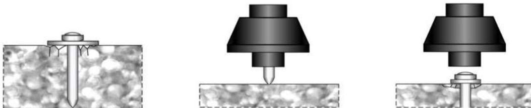
Несущая способность монтажной точки зависит от глубины захода дюбеля. В зависимости от типа дюбеля и материала основания достаточным будет заглубление от 22-30 мм (в бетоне) до 30-40 мм (в кирпиче). В случае большей длины заглубляемой части повышается вероятность изгиба дюбеля, чего можно избежать выбором более мощного патрона.
