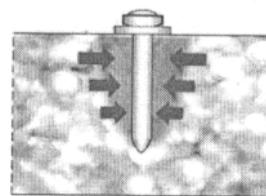
Дюбель входит в бетон, частично вытесняет его и уплотняет вокруг себя, создавая напряжение. Кроме того, сила трения при входе дюбеля создает тепло (температура доходит до 900°C), благодаря которому происходит схватывание дюбеля и бетона.
