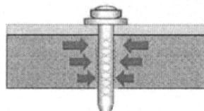
При заходе дюбеля в стальное основание, благодаря эластичности металла, возникает давление на стержень дюбеля, удерживающее его в отверстии, а так же появляются силы сцепления благодаря диффузионному схватыванию и привариванию его к металлу основания.
