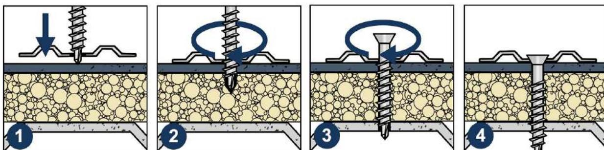
\* Выбор шурупа для крепления определяется в соответствии с видом материала основания и размерами установочного отверстия.
