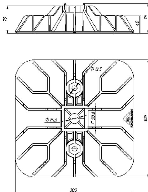
Рис. 1. Размеры кровельной опоры EASY FOOT 300x300 41/21
