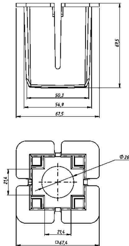
Рис. 4. Размеры вставки опоры EASY FOOT 21
