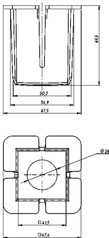
Рис. 3. Размеры вставки опоры EASY FOOT 41
