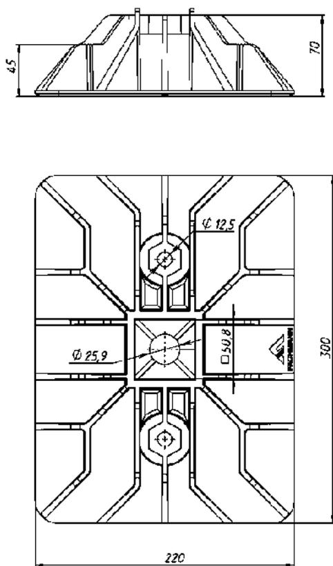
Рис. 2. Размеры кровельной опоры EASY FOOT 300x220 41/21
