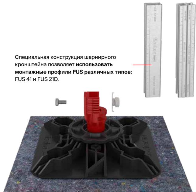
Опора для плоской кровли fischer с шарнирным кронштейном FFRBH допускает вертикальную установку монтажных профилей FUS в соответствии с требованиями заказчика. За счет чего создается надежная конструкция для выполнения монтажа различных агрегатов, кровельных мостиков, трубопроводов и кабельных лотков.
