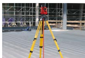
Быстрая установка при использовании лазерного отвеса
