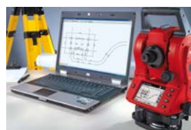
Перенос чертежей на тахеометр
