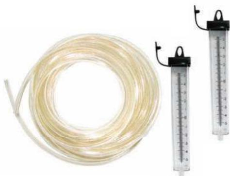
Для определения равных высотных отметок на больших расстояниях.
