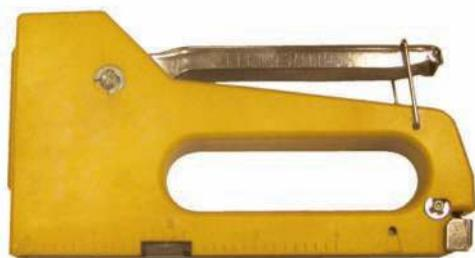
Изготовлен из ударопрочного пластика. Используется с прямоугольными скобами шириной 11,3 мм и высотой от 4 до 8 мм. В комплект входят 50 скоб высотой 6 мм. Для крепления изоляционного материала, панелей и облицовки к поверхностям из дерева, ДВП, гипсокартона, пластика.
