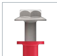
Бортик дюбеля предотвращает мостик холода
