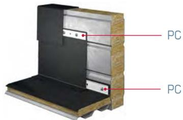
Рейка выполнена из углеродистой стали со стойким антикоррозионным покрытием.
