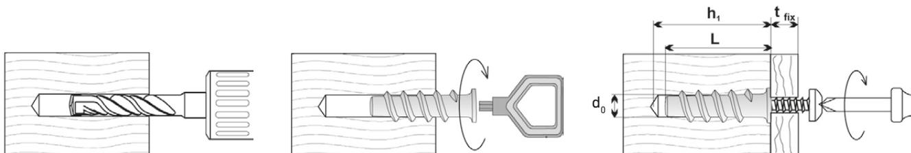
Просверлите отверстие в соответствии с параметрами установки. Установите анкер, пользуясь специальным инструментом или шестигранным ключом (см. параграф «установочные инструменты»).
