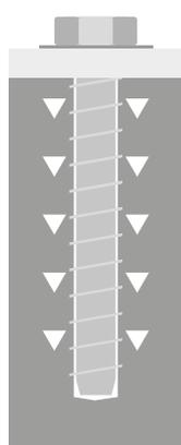
шурупы по бетону
