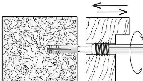
Регулировка коробки производится с помощью противоположного конца установочного ключа.
