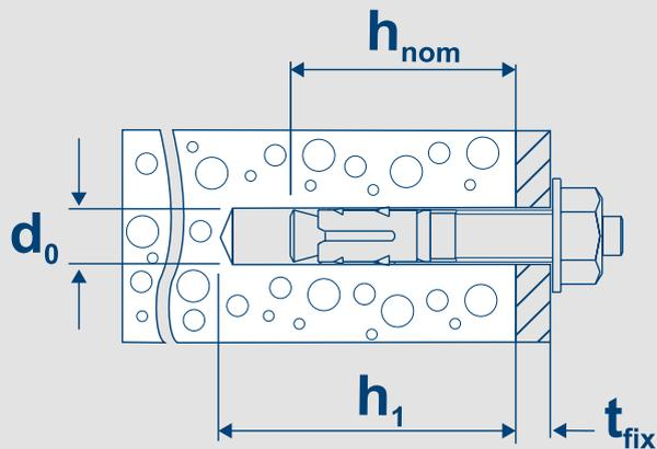
$t_{fix}$  = ТОЛЩИНА ПРИКРЕПЛЯЕМОГО МАТЕРИАЛА
