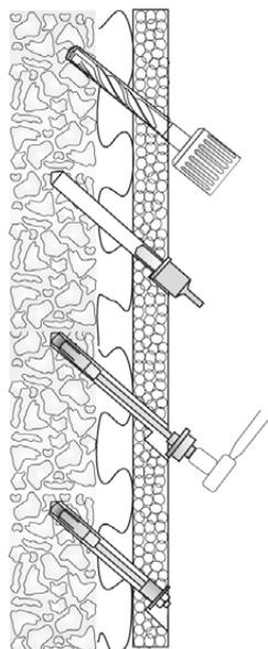
ПРОСВЕРЛИТЕ ОТВЕРСТИЕ 14 мм ПОД УГЛОМ ИЛИ ПЕРПЕНДИКУЛЯРНО ПЛОСКОСТИ НЕСУЩЕЙ КОНСТРУКЦИИ. ГЛУБИНА ОТВЕРСТИЯ ЗАВИСИТ ОТ СТРУКТУРЫ МАТЕРИАЛА И ОТ ВЕЛИЧИНЫ НАГРУЗКИ.
