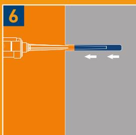
**5** Двухкомпонентная химическая крепежная смола смешивается в насадке-смесителе. Выдавите смолу 10 см или более, до равномерного смешивания.
