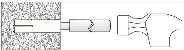
Установите анкер в отверстие. Забейте клин, находящийся внутри анкера, до дна специальным инструментом (LT+).
