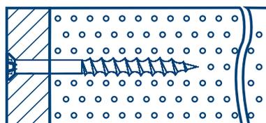
2. Минимальная глубина установки 60 мм. При монтаже рекомендуется использовать динамометрический ключ, чтобы избежать перетягивания шурупа.
