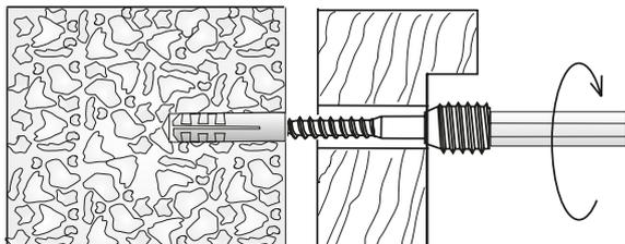
Установите регулируемый винт с подходящим креплением через готовое отверстие в коробке, используя специальный установочный ключ.
