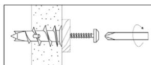
Установите KLA с помощью отвертки или шуруповерта. Закрепите материал шурупом.
