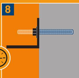
**7** Вставьте шпильку вращая для равномерного распределения массы. Соблюдайте время схватывания и отверждения, прежде чем нагружать анкер!
