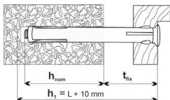
$t_{fix}$  макс. толщина прикрепляемого материала
