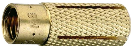
Латунные анкеры MSA предназначены для легких и умеренно тяжелых нагрузок при использовании в твердых материалах: таких как бетон, полнотелый кирпич и природный камень. Анкер устанавливается с помощью резьбовой шпильки или болта, которые одновременно используются и для закрепления материала.
