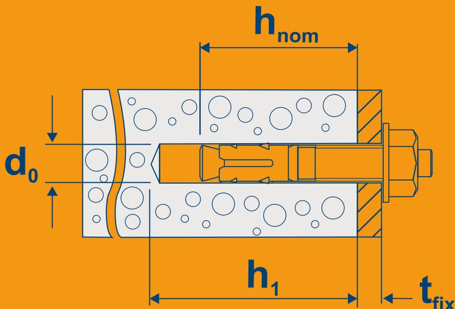
На глубину монтажа следует обратить особое внимание, если материал основания покрыт штукатуркой, облицовкой или слоем изоляции. В этом случае толщина не несущего слоя должна быть добавлена к максимальной длине  $t_{fix}$  анкера.
