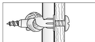
Закрепите материал соответствующим шурупом.
