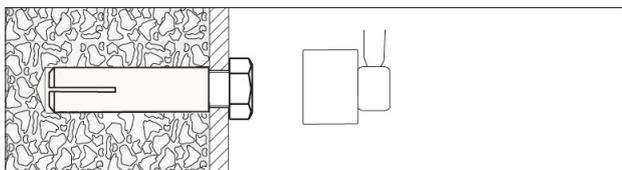
Притяните прикрепляемую деталь подходящим инструментом.
