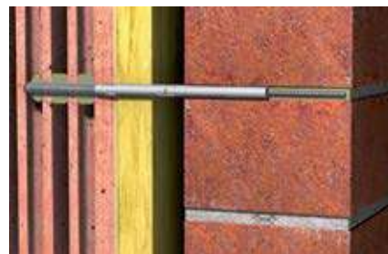
Фрагмент: Ремонт облицовки
